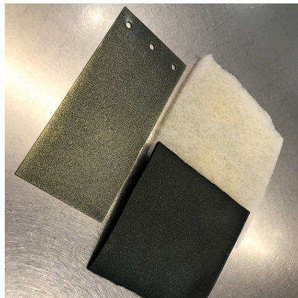
粉体塗装技術を利用した研磨材 (開発段階)
