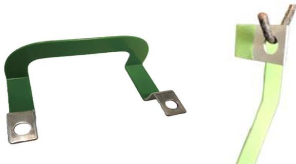
塗装工程では、製品を保持するために鉄製の治具（ハンガー）が使用されます。塗装後、治具に付着した塗料はショットブラストや薬液等で剥離して再利用されますが、作業効率や治具の摩耗が懸念点となっています。当社では課題解決手法として、レーザー加工による剥離もご提案させていただいております。
